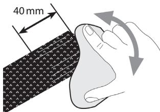
Lijar suavemente los últimos 40 mm del tubo de fibra de carbono con un estropajo Scotch-Brite del n.º 7486 (verde) (937033).
