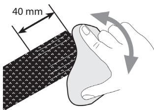
Desbaste ligeiramente os últimos 40 mm do tubo de fibra de carbono utilizando o esfregão Scotch-Brite n.º 7486 (verde) (937033).
