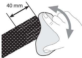
Abrasez légèrement les 40 derniers mm du tube en fibre de carbone à l'aide du tampon Scotch-Brite n° 7486 (vert) (937033).
