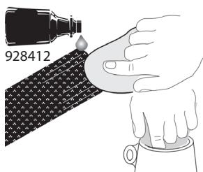
Limpe minuciosamente a extremidade do tubo de fibra de carbono e o interior da estrutura de fixação. Utilize uma solução de limpeza adequada como a acetona (928412). Deixe secar.
