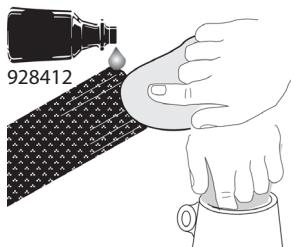
Nettoyez soigneusement l'extrémité du tube en fibre de carbone et l'intérieur du logement du serre-tube. Utilisez un solvant nettoyant approprié tel que l'accétone (928412). Laissez sécher. NE MANIPULEZ PAS LES ZONES NETTOYÉES.
