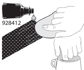
Důkladně očistěte konec trubky z uhlíkových vláken a vnitřek pouzdra svorky. Použijte vhodné rozpouštědlové ředidlo, například aceton (928412). Nechte uschnout. S VYČIŠTĚNÝMI OBLASTMI NEMANIPULUJTE.
