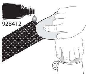
Należy dokładnie wyczyścić końcówkę tulei z włókna węglowego i przylegającą zaciskającą płaszczyznę obejmę. Należy użyć do tego odpowiedniego rozpuszczalnika, na przykład acetenu (928412). Pozostawić do wyschnięcia.
