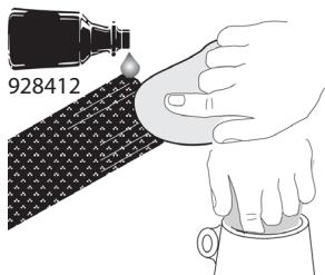
Het uiteinde van de koolstofvezelbus en de binnenkant van de klembehuizing moeten grondig worden gereinigd. Gebruik een geschikt oplosmiddelhoudend reinigingsmiddel zoals aceton (928412). Laat alle onderdelen drogen.
