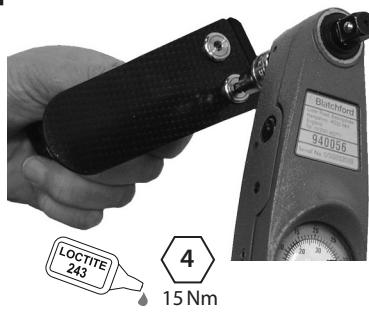
Montér den nye hælfjeder, påfør Loctite 243 på skrugevindene, og stram til et moment på 15 Nm.
