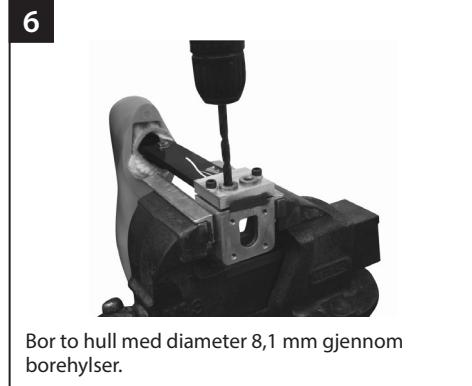
Bor to hull med diameter 8,1 mm gjennom borehylser.
