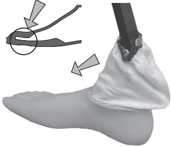
Monter enheten i fotskallet, og før tuppen av røret inn i fotskallet.
