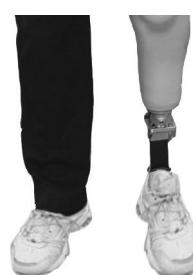
让用户站立，进行动态对线和行走试验。调整高度，达到确定的长度，同时使重量均匀分布。
