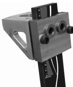
Обрежьте мысочную пружину динамического несущего модуля голени (пилон) на 10–15 мм длиннее, чем требуется и установите обрезной стяжной адаптер-кондуктор (941255).
