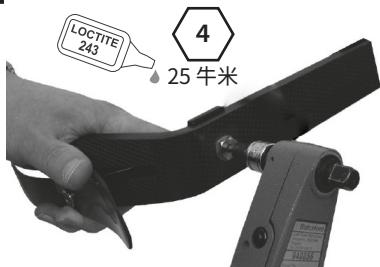
将连接管安装到龙骨上。给螺栓涂抹乐泰 243 防松胶并拧紧至 25 牛米。
