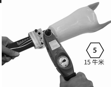
将安装夹螺栓拧紧至 15 牛米。
