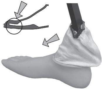
将总成装入脚套,使连接管上的前掌部分合入脚套中。
