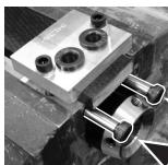
Снимите гильзу, аккуратно зажмите обрезной стяжной адаптер-кондуктор в тисках и обрежьте по длине. Для предотвращения повреждения компонентов установите предохранительные винты с буртиком.
