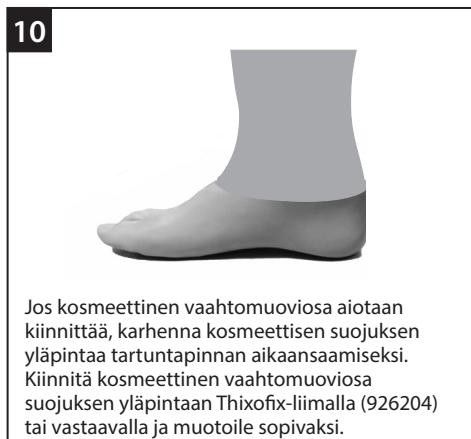
Jos kosmeettinen vahtomuoviosa aiotaan kiinnittää, karhenna kosmeettisen suojuksen yläpinta tartuntapinnan aikaansaamiseksi. Kiinnitä kosmeettinen vahtomuoviosa suojuksen yläpintaan Thixofix-liimalla (926204) tai vastaavalla ja muotoile sopivaksi.
