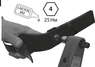
Подсоедините мысочную пружину несущего модуля голени к несущей пружине пятки. Используйте резьбовой фиксатор Loctite 243 и затяните винт с усилием в 25 Нм.
