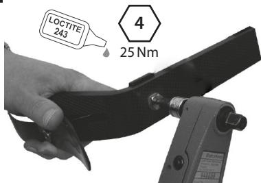
Sæt pylonen på bæreenheden. Påfør Loctite (243), og stram bolten til (25 Nm).
