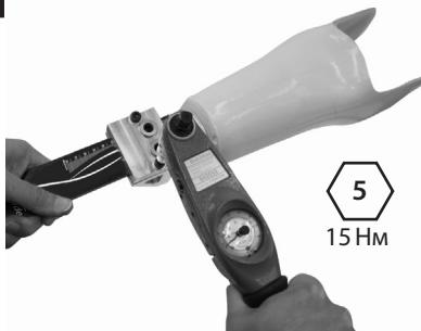
Затяните крепежные винты обрезного стяжного адаптера-кондуктора с усилием 15 Нм (дважды проверьте затяжку винтов).
