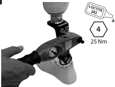
Katkaise putki edellä kuvatulla tavalla ennen kuin kiinnität sen yläkoteloon. Sivele Loctite-kierrelukitetta (243) ja kiristä pultit (25 Nm). Laita tarvittaessa kosmeettinen osa takaisin paikalleen.
