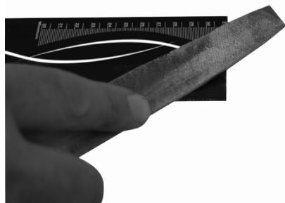
去除连接管端部的毛刺。
