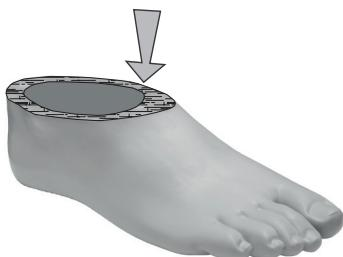
如需安装装饰泡沫,请将脚套顶面打磨粗糙,以获得理想的粘合面。
