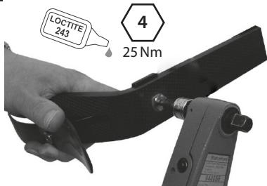
Kiinnitä putki kannattimeen. Sivele Loctite-kirrelukitetta (243) ja kiristä pultti (25 Nm).
