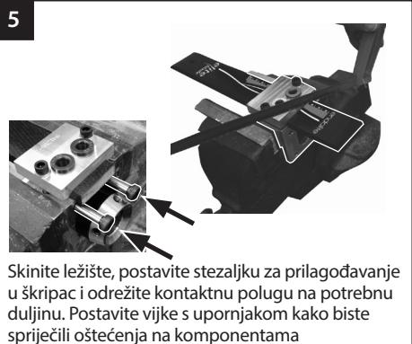
Skinite ležište, postavite stezaljku za prilagođavanje u škripac i odrežite kontaktnu polugu na potrebnu duljinu. Postavite vijke s upornjakom kako biste sprječili oštećenja na komponentama
