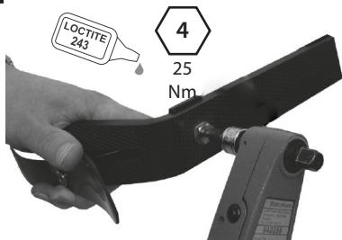
Pritvirtinkite atramą prie laikiklio. Užtepkite „Loctite 243“ ir užveržkite varžtą (25 Nm).
