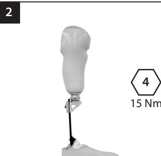
Namestite ležišče v zgornje ohišje pritrdirilne objemke in zategnjite vijake za piramidni adapter (15 Nm). Za začetno nastavitev glejte stran za poravnavo.
