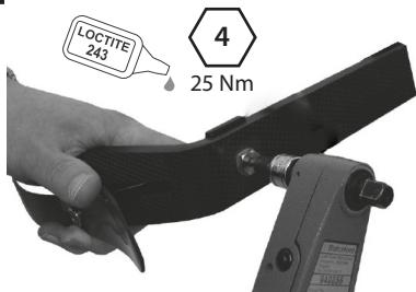
Pritrdite palico na nosilec. Nanesite Loctite 243 in zategnite vijak (25 Nm).
