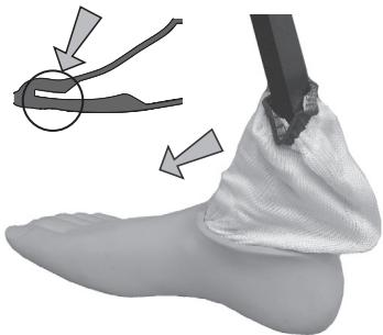
Ievietojiet konstrukciju pēdas apvalkā, uzstādiet pilona pirkstu pēdas apvalkā.
