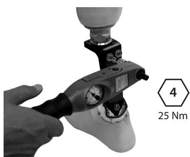
Užtepkite „Loctite 243“ ir užveržkite (25 Nm) viršutinio korpuso varžtus. Pritvirtinkite ir sulygiuokite bigės émiklj.
