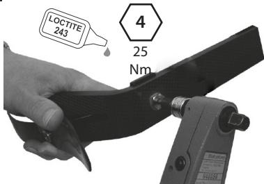
Pripojte pylón k nosníku. Naneste Loctite (243) a dotiahnite skrutku (25 Nm).
