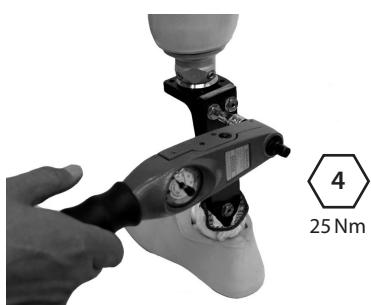
Εφαρμόστε Loctite (243) και σφίξτε (25 Nm) τους κοχλίες του άνω περιβλήματος. Συνδέστε και ευθυγραμμίστε τη θήκη.
