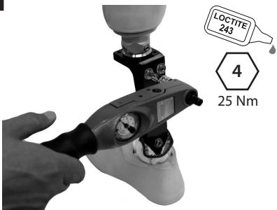
Pirms uzvilkta virsējo korpusu, apgrieziet pilonu, izmantojot iepriekš aprakstīto metodi. Uzklājiet Loctite (243) un pievelciet skrūves (25 Nm). Atkārtoti uzvelciet estētisko pārvalku, ja tas tiek izmantots.
