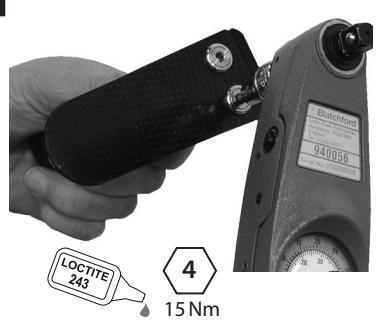
Sklopite zamjensku oprugu pete nanošenjem ljepila Loctite 243 na vijčane navoje i zategnite na okretni moment od 15 Nm.
