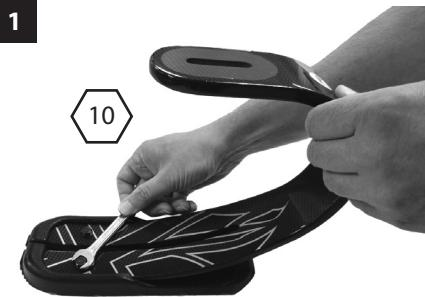
Lösen Sie die 2 Schrauben, die die Fersenfeder halten.
