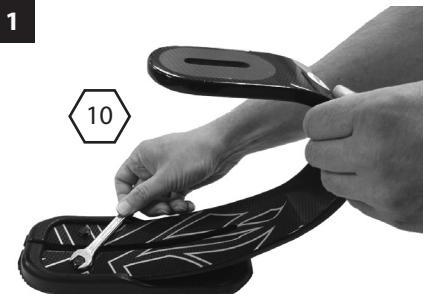
Défaitez les 2 boulons de retenue de la lame de talon.
