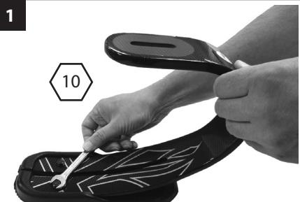
Odkręcić 2 śruby mocujące sprężynę na pięcie.
