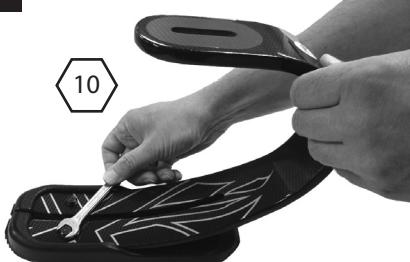
Desaperte os 2 parafusos de fixação da lâmina posterior.
