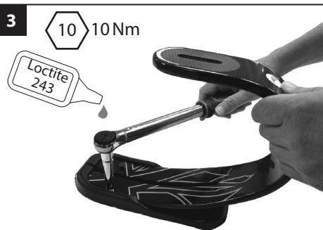
Colocar la ballesta de la puntera en la cubierta de la ballesta del talón y apretar los tornillos hasta un par de 10 Nm.
