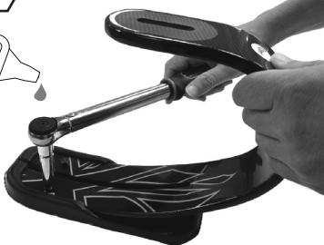
Encaixe a lâmina anterior na cobertura da lâmina posterior e aperte os parafusos com um binário de aperto de 10 Nm.
