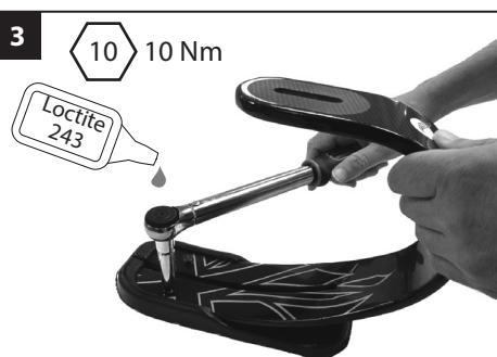
Przymocować sprężynę palców do osłony sprężyny pięty i dokręcić śruby momentem 10 Nm.
