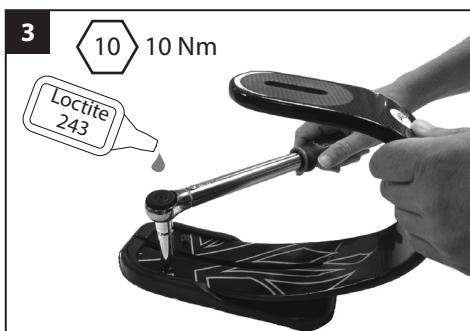
Insérez la lame d'avant-pied dans le revêtement de la lame de talon et serrez les boulons à 10 Nm.
