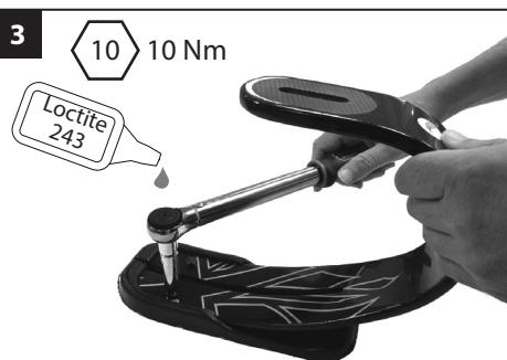
Passen Sie die Vorfußfeder in die Abdeckung der Fersenfeder ein, und ziehen Sie die Schrauben mit 10 Nm an.
