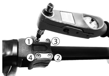
Равномерно затяните стяжные винты с усилием в 5 Нм, при этом затягивать винты следует попеременно, по крайней мере, два раза для каждого винта. Примерный порядок затягивания винтов, для получения равномерного затягивания приведен на рисунке.
