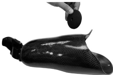
Tillverka hylsan med lämplig enkelbultsformare från Blatchford. Skär ett hål med 27 mm diameter i hylsans distala ände. Placera hylsplattan inuti hylsan. Montera de medföljande inriktningsdelarna. Minsta hylstjocklek 6 mm.
