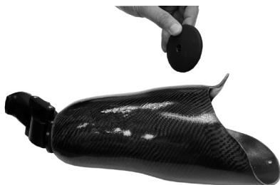
使用适当的 Blatchford 单螺栓模型制作接受腔。在接受腔末端切出一个直径 27 毫米的孔。将接受腔安装板置于接受腔内。装配随附的对线零件。接受腔最小厚度 6 毫米。
