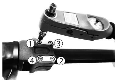
均匀拧紧各夹紧螺钉，以 5 牛米的扭矩将每个螺钉拧紧至少两次。图中为紧固顺序示例，此顺序有助于均匀分布载荷。
