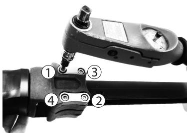
Stram klemmeskruerne ens, og stram til et moment på 5 Nm, mindst to gange for hver skrue. Eksempel på rækkefølgen af tilspænding for at fordele belastningen ligeligt.
