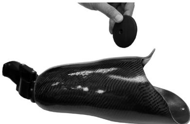
Изготовьте гильзу протеза с применением подходящего одноболтового формирователя торца гильзы. В дистальной части гильзы вырежьте отверстие диаметром 27 мм. Поместите гильзовую пластину внутрь гильзы. Установите входящие в комплект крепежные части юстировки. Минимальная толщина гильзы 6мм.
