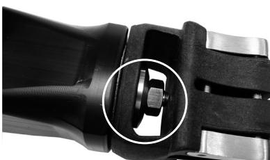
Påfør Loctite 243 på boltegjengene. Monter det distale toppdekselet ved hjelp av mutteren og skiven, som vist, og stram til 35 Nm etter innretting.
