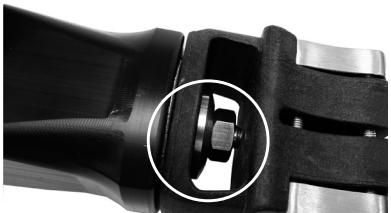
Нанести немного резьбового фиксатора Loctite 243 на резьбу болта. Соберите дистальный верхний корпус установив шайбу и гайку так, как это показано на рисунке, затяните с усилием в 35Нм после проведения юстировки.
