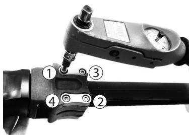
Stram klemskruene jevnt ved å stramme hver skrue med 5 Nm minst to ganger. Eksempelet viser strammerekkefølge som gir jevn belastningsfordeling.
