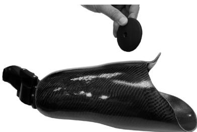
Fremstil hylstret ved brug af den passende Blatchford formgiver til enkeltbolte. Skær et hul på 27 mm i diameter i hylstrets distale ende. Anbring hylsterpladen i hylstret. Montér de medfølgende justeringsdele. Minimal hylstertykkelse er 6 mm.
