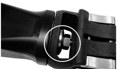
Sivele Loctite 243 -kierrelukitetta pultin kierteisiin. Kokoa distaalinen yläkotelo mutterin ja välirenkaan kanssa kuten kuvassa on esitetty ja kiristä 35 Nm:n kireyteen linjauksen jälkeen.
