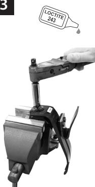
Przymocować sprężynę palców do zespołu nośnego i zabezpieczyć gwinty śrub klejem Loctite 243 (926012).
