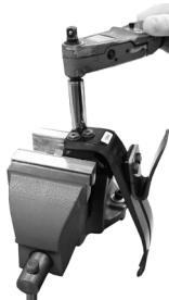
Collegare la lamina anteriore al supporto applicando sui bulloni del Loctite 243 (926012).
