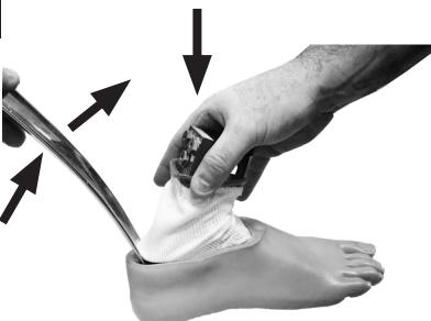
Zasuňte kovový roh obuvi mezi patní pružinu a zadní část otvoru skořepiny chodidla a zatlačte pružinu dolů do skořepiny chodidla.
