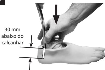
Pressione a lâmina posterior para que fique corretamente colocada no revestimento cosmético, como ilustrado. A calçadeira deve ser posicionada cerca de 30 mm abaixo da superfície superior do revestimento cosmético do pé
