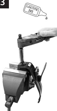
Fixe a lâmina anterior ao suporte aplicando Loctite 243 (926012) nos parafusos.
