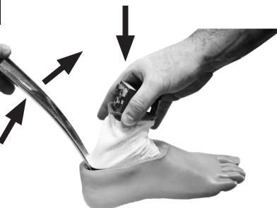
Metallschuhanzieher zwischen Fersenfeder und den hinteren Bereich der Fußkosmetik schieben und die Feder in die Fußkosmetik heben.
