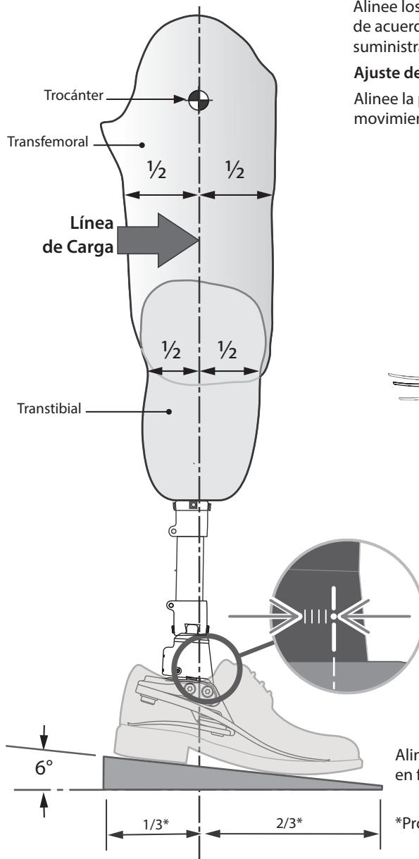
Mantenga la línea de carga entre los pivotes tal y como se muestra, usando los dispositivos de ajuste y/o inclinación necesarios.
