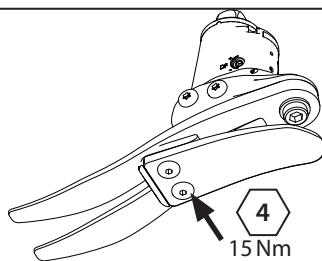
Rimontare la lamina del tallone sostitutiva. Utilizzare Loctite 243 (926012) e un serraggio di 15 Nm.
