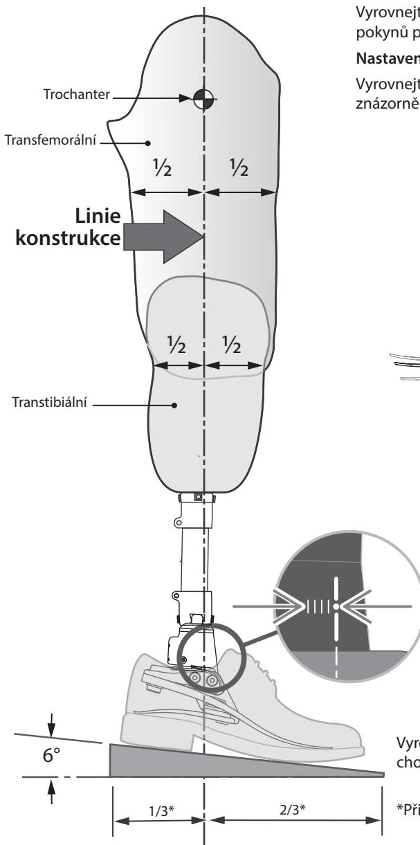
Udržujte linii konstrukce mezi čepy, jak je znázorněno, podle potřeby používejte zařízení pro posun a/nebo náklon.
