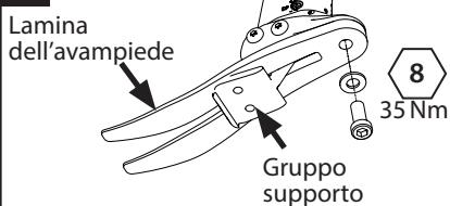
Rimuovere la vite della lamina anteriore e sostituire le dita. Durante il rimontaggio, utilizzare Loctite 243 (926012) e un serraggio di 35 Nm. Accertarsi che la lamina anteriore sia al centro del supporto.
