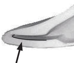
Position de la lame d'avant pied dans l'enveloppe.
