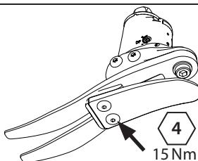
Setzen Sie dies mit der ausgewechselten Fersenfeder zusammen, Verwenden Sie Loctite 243 (926012) und sichern die Schrauben mit 15 Nm drehen.
