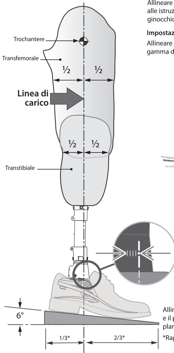
Mantenere la linea di carico entro i perni come illustrato, utilizzando se necessario i dispositivi di scorrimento e/o di inclinazione.
