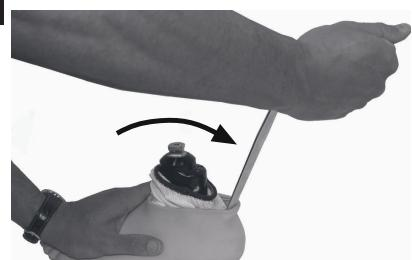
Obrócić łyżkę do butów, jak przedstawiono to na rysunku, aby wyjąć skarpetę ochronną.
