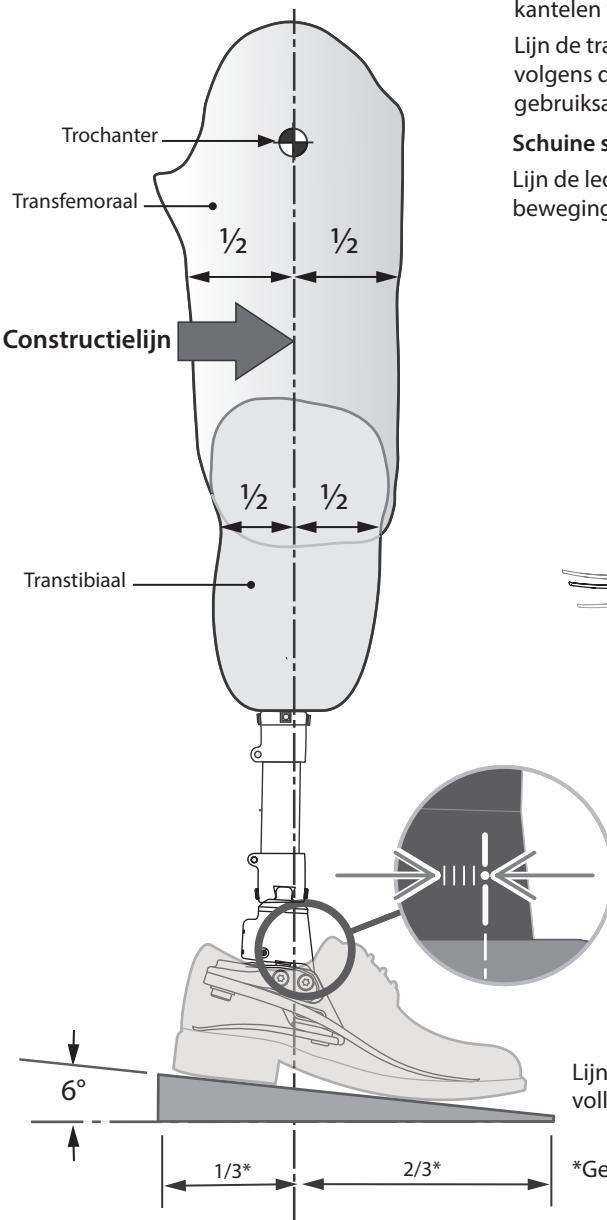
Houd de middellijn van de constructie tussen de draaipunten zoals op de afbeelding is aangegeven, door het verschuiven en/of kantelen van hulpmiddelen waar nodig.
