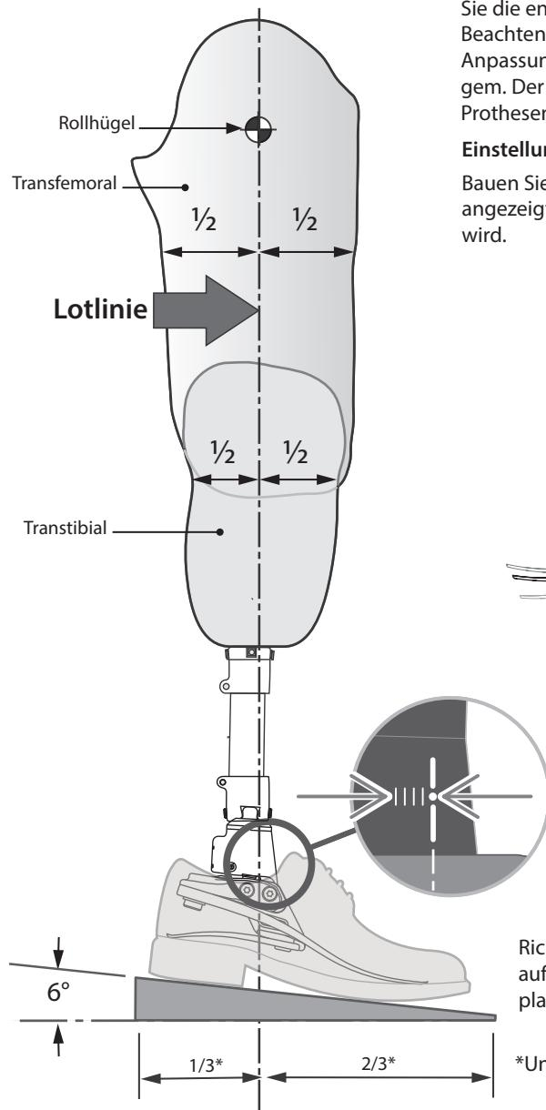
Achten Sie darauf, dass die Lotlinie, wie in der Abbildung dargestellt, zwischen den Pfeilen verläuft. Nach Bedarf kippen oder verschieben Sie die entsprechenden Bauteile. Beachten Sie bei der transfemoralen Anpassung die entsprechende Aufbaurichtlinie gem. Der Gebrauchsanweisung des Prothesenkniegelenkes.
