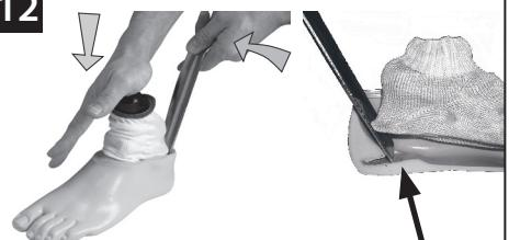
rozcięcie na sprężynę na pięcie
