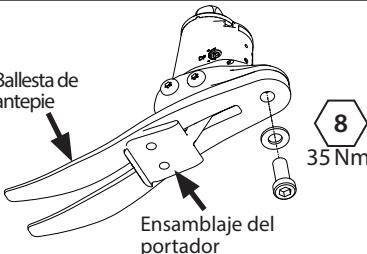
Retire el tornillo, de la ballesta del antepié y reemplace la puntera. Una vez re-ensamblado, use Loctite 243 (926012) y torque hasta los 35 Nm.
