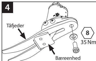
Fjern skruen til tåfjederen, udskift tåen. Anvend Loctite 243 (926012) under genmontering og et moment på 35 Nm. Kontrollér, at tåfjederen er i midten i forhold til bæreenheden.
