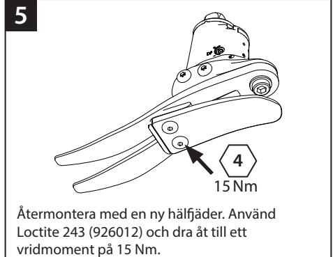
Återmontera med en ny hälfjäder. Använd Loctite 243 (926012) och dra åt till ett vridmoment på 15 Nm.
