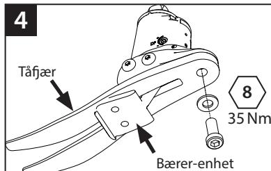
Fjern tåfjærskruen og skift ut tåproesen. Til remontering bruker du Loctite 243 (926012) og et moment på 35 Nm. Kontroller at tåfjæren er midtstilt på bæreren.
