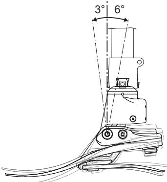
Se avsnitt 9.3 *Montering av vakuumsystemet* for montering av vakuumsystemet. Vikle vakuumslangen rundt masten som vist, og plasser kontrollventilen nærmere ankelen for best mulig vakuумytelse.
