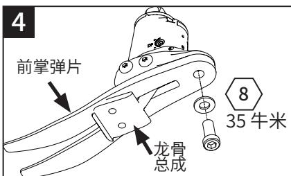
卸下前掌弹片螺丝，更换前掌弹片。重新装配好后，涂抹乐泰 243 (926012) 防松胶并拧紧至 35 牛米。确保前掌弹片位于龙骨的中心位置。
