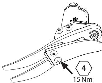
Remontér med ny hælfjær. Bruk Loctite 243 (926012) og et moment på 15 Nm.
