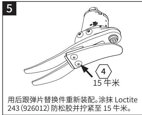
用后跟弹片替换件重新装配。涂抹 Loctite 243 (926012) 防松胶并拧紧至 15 牛米。
