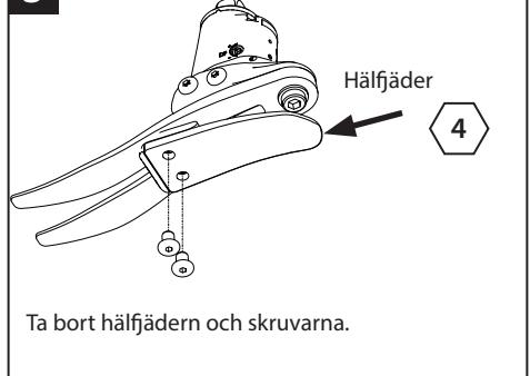
Ta bort hälfjädern och skruvarna.
