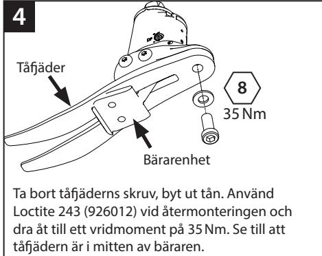
Ta bort tåfjäderns skruv, byt ut tån. Använd Loctite 243 (926012) vid återmonteringen och dra åt till ett vridmoment på 35 Nm. Se till att tåfjädern är i mitten av bäraren.
