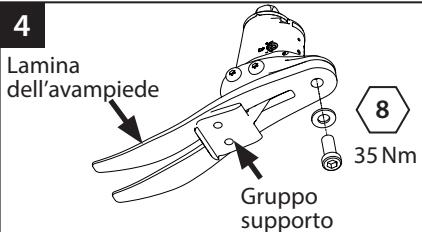
Rimuovere la vite della lamina anteriore e sostituire le dita. Durante il rimontaggio, utilizzare Loctite 243 (926012) e un serraggio di 35 Nm. Accertarsi che la lamina anteriore sia al centro del supporto.
