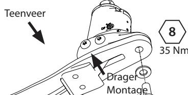
Verwijder de teenveerschroef en vervang de teen. Gebruik bij het opnieuw in elkaar zetten Loctite 243 (926012) en zet vast met een moment van 35 Nm. Zorg ervoor dat de teenveer in het midden op de drager zit.
