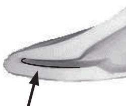
Position de la lame d'avant pied dans l'enveloppe.
