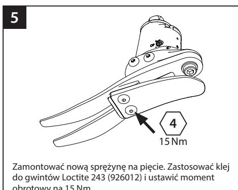
Zamontować nową sprężynę na pięcie. Zastosować klej do gwintów Loctite 243 (926012) i ustawić moment obrotowy na 15 Nm.
