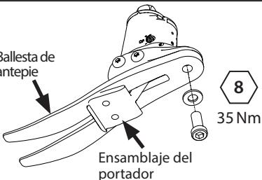
Retire el tornillo, de la ballesta del antepié y reemplace la puntera. Una vez re-ensamblado, use Loctite 243 (926012) y torque hasta los 35 Nm.
