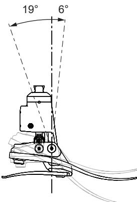
La cheville peut être alignée avec une amplitude de flexion dorsale réduite de  $3^\circ$  pour s'adapter aux patients qui nécessitent un soutien supplémentaire en position debout, par exemple les patients bilatéraux. Remarque : Cela entraînera une augmentation de l'amplitude de la flexion dorsale à  $22^\circ$ .
