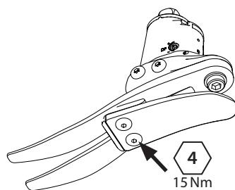
Volte a montar com a lâmina posterior de substituição. Aplique Loctite 243 (926012) e um binário de aperto de 15 Nm.
