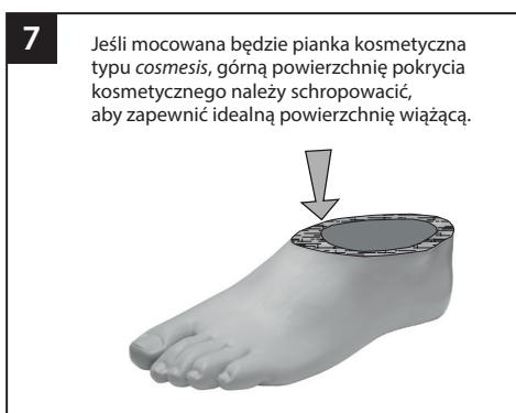
7 Jeśli mocowana będzie pianka kosmetyczna typu cosmesis, górną powierzchnię pokrycia kosmetycznego należy schropować, aby zapewnić idealną powierzchnię wiążącą.
