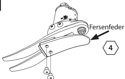
Entfernen Sie die Fersenfeder und die Schrauben.
