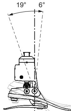
De enkel kan worden uitgelijnd met een lager DF-bereik van  $3^\circ$  volgens de wens van gebruikers die bij het staan extra hulp nodig hebben, bv. personen met tweezijdige prothesen. Merk op dat dit leidt tot een PF-bereik dat stijgt tot  $22^\circ$ .
