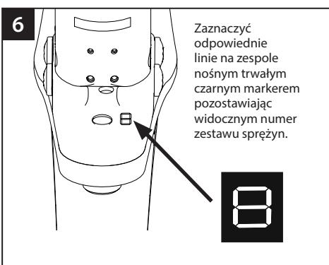
Zaznaczyć odpowiednie linie na zespole nośnym trwałym czarnym markerem pozostawiając widocznym numer zestawu sprężyn.
