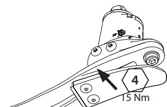
Zet de eenheid weer in elkaar met de nieuwe hielveer. Gebruik Loctite 243 (926012) en zet het geheel vast met een moment van 15 Nm.
