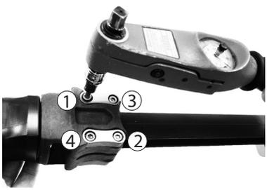
Egyenletesen húzza meg a bilincs csavarjait, legalább kétszer 5 Nm forgatónyomatéket alkalmazva minden csavaron. Példa a csavarok meghúzásának sorrendjére a terhelés egyenletes eloszlása érdekében.
