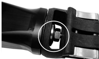
Na navoje vijakov nanesite Loctite 243. Montirajte distalni zgornji del ohišja z matico in podložko, kot je prikazano, in po poravnavi privijte z zateznim momentom 35 Nm.
