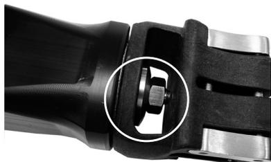
Uzklājiet Loctite 243 skrūves vītņēm. Samontējiet distālo augšējo apvalku, lietojot uzgriezni un paplākšni, un pēc salāgošanas pievelciet līdz 35 Nm.
