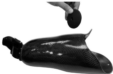
Изгответе приемната гилза, като използвате подходящия шаблон с единичен болт на Blatchford. Изрежете отвор с диаметър 27 мм в дисталния край на приемната гилза. Поставете пластината за приемната гилза в нея. Монтирайте предоставените части за центроване. Минималната дебелина на приемната гилза е 6 мм.
