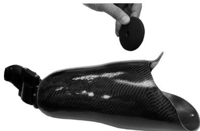
Ležišče izdelajte z ustreznim oblikovalnim elementom z enojnim sornikom Blatchford. Na distalnem koncu ležišča izrežite luknjo s premerom 27 mm. Vstavite ploščo ležišča v ležišče. Sestavite priložene poravnalne dele. Najmanjša debelina ležišča je 6 mm.
