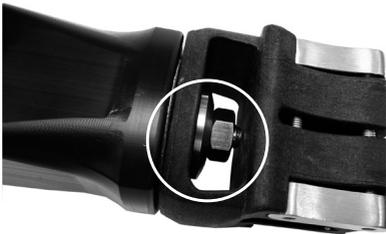
Εφαρμόστε Loctite 243 σε όλα τα σπειρώματα κοχλιών. Συναρμολογήστε το περιφερικό άνω περιβλήμα με το παξιμάδι και τη ροδέλα, όπως απεικονίζεται, και σφίξτε με ροπή 35 Nm μετά την ευθυγράμμιση.
