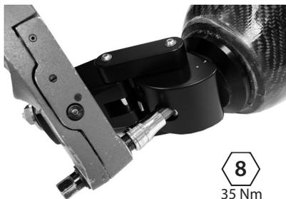
Naneste Loctite 243 a proximálnu zarovňavaciu skrutku dotiahnite na ťahovací moment 35 Nm. Rotácii odliatku lôžka zabránite kolíkovým kľúčom (940060).
