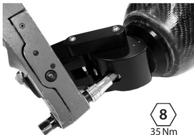
Nanesite ljepilo 243 i zategnite proksimalni vijak za poravnanje na okretni moment od 35 Nm. Upotrijebite klinasti ključ (940060) za sprječavanje zakretanja pločice ležišta.
