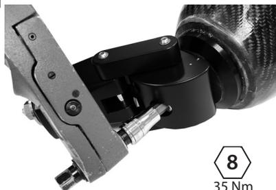
Nanesite Loctite 243 in privijte proksimalni poravnalni sornik z zateznim momentom 35 Nm. Z matičnim ključem (940060) držite ploščo ležišča, da se ne bo vrtela.
