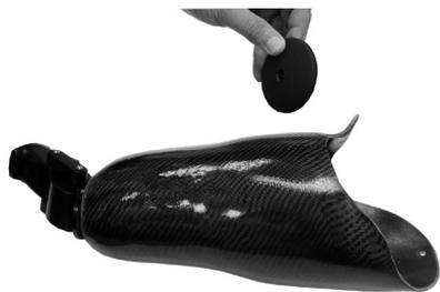
Izgatavojiet uzmavu, lietojot atbilstošu Blatchford formētāju ar vienu skrūvi. Uzmavas distālajā galā izgrieziet 27 mm diametra atveri. Ievietojiet uzmavas plāksni uzmavā. Samontējiet piegādātās sastāvdaļas. Minimālais uzmavas biezums ir 6 mm.
