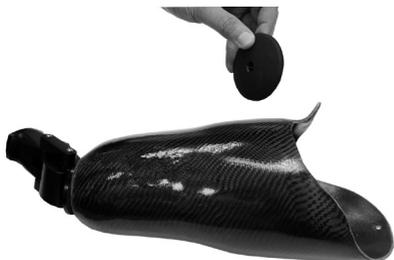
Pomocou vhodnej jednoskrutkovej formy Blatchford vyrobte lôžka. Na distálnom konci lôžka vyvrtajte otvor s priemerom 27 mm. Do lôžka vložte odliatok lôžka. Zložte priložené zarovňavacie diely. Minimálna hrúbka lôžka je 6 mm.
