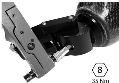
Uzklājiet Loctite 243 un pievelciet priekšējo salāgošanas skrūvi līdz 35 Nm. Lietojiet tapas uzgriežņu atslēgu (940060), lai novērstu uzmavas plāksnes rotēšanu.
