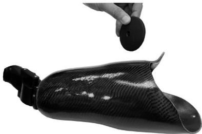
Izradite ležište pomoću odgovarajućeg jednovijčanog oblikovača Blatchford. Izbušite otvor promjera 27 mm u distalnom kraju ležišta. Umetnite pločicu ležišta u ležište. Sklopite isporučene dijelove za poravnanje. Minimalna debljina ležišta 6 mm.
