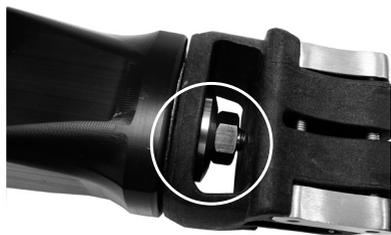
Нанесете Loctite 243 върху резбата на болта. Монтирайте дисталния горен корпус, като използвате гайката и шайбата както е показано на фигурата, и затегнете със сила на затягане от 35 Nm след центроване.
