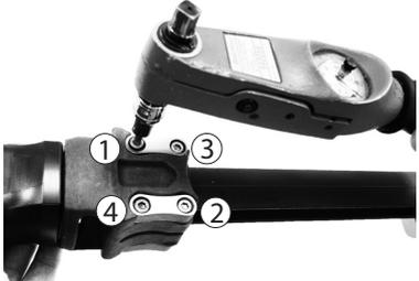
Затегнете равномерно затягащите винтове със сила на затягане от 5 Nm, като го направите най-малко два пъти за всеки винт. Показан е примерен ред на затягане за равномерно разпределяне на натоварването.
