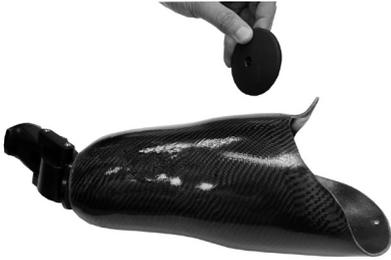
Κατασκευάστε τη θήκη χρησιμοποιώντας τον κατάλληλο διαμορφωτή Blatchford ενός κοχλία. Κόψτε μια σπή διαμέτρου 27 mm στο περιφερικό άκρο της θήκης. Τοποθετήστε την πλάκα θήκης μέσα στη θήκη. Συναρμολογήστε τα εξαρτήματα ευθυγράμμισης που παρέχονται. Ελάχιστο πάχος θήκης 6 mm.
