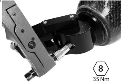
Εφαρμόστε Loctite 243 και σφίξτε τον εγγύς κοχλία ευθυγράμμισης με ροπή 35 Nm. Χρησιμοποιήστε ένα κλειδί με προεσοχές (940060) για να αποτρέψετε την περιστροφή της πλάκας θήκης.
