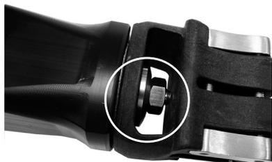
Užtepkite „Loctite 243“ ant varžtų sriegio. Surinkite distalinį viršutinį korpusą su veržle ir poveržle, kaip parodyta, ir sulygiavę užveržkite 35 Nm sukimo momentu.
