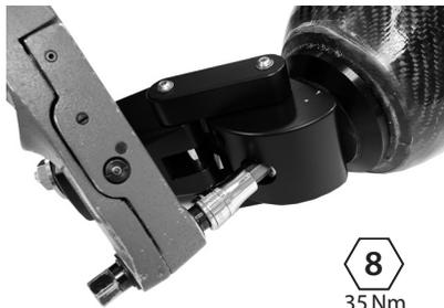
Нанесете Loctite 243 и затегнете проксималния болт за центроване със сила на затягане от 35 Nm. Използвайте гаечен ключ (940060), за да предотвратите въртене на пластината на приемната гилза.
