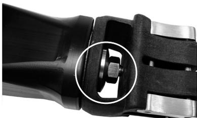
Na závitý skrutiek naneste Loctite 243. Zložte distálny vrchný kryt pomocou matky a podložky ako vidno na obrázku a po zarovnaní ich dotiahnite na ťahovací moment 35 Nm.
