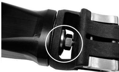
Nanesite ljepilo Loctite 243 na navoje vijaka. Sklopite gornje distalno kućište pomoću matice i podloške kako je prikazano i zategnite na okretni moment od 35 Nm nakon poravnanja.
