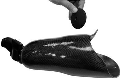
A tokot a megfelelő Blatchford egycsapos formázó segítségével gyártsa. A tok disztális végén vágjon 27 mm átmérőjű lyukat. Helyezze a tokba a toklemez. Szerelje össze a mellékelt illesztő alkatrészeket. A minimális tokvastagság 6 mm.
